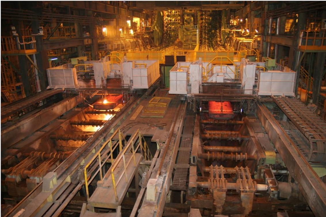
台湾钢铁企业中钢公司(CSC)高雄厂的板坯连铸机。普锐特冶金技术将对该厂的 S6 号板坯连铸机进行升级。
