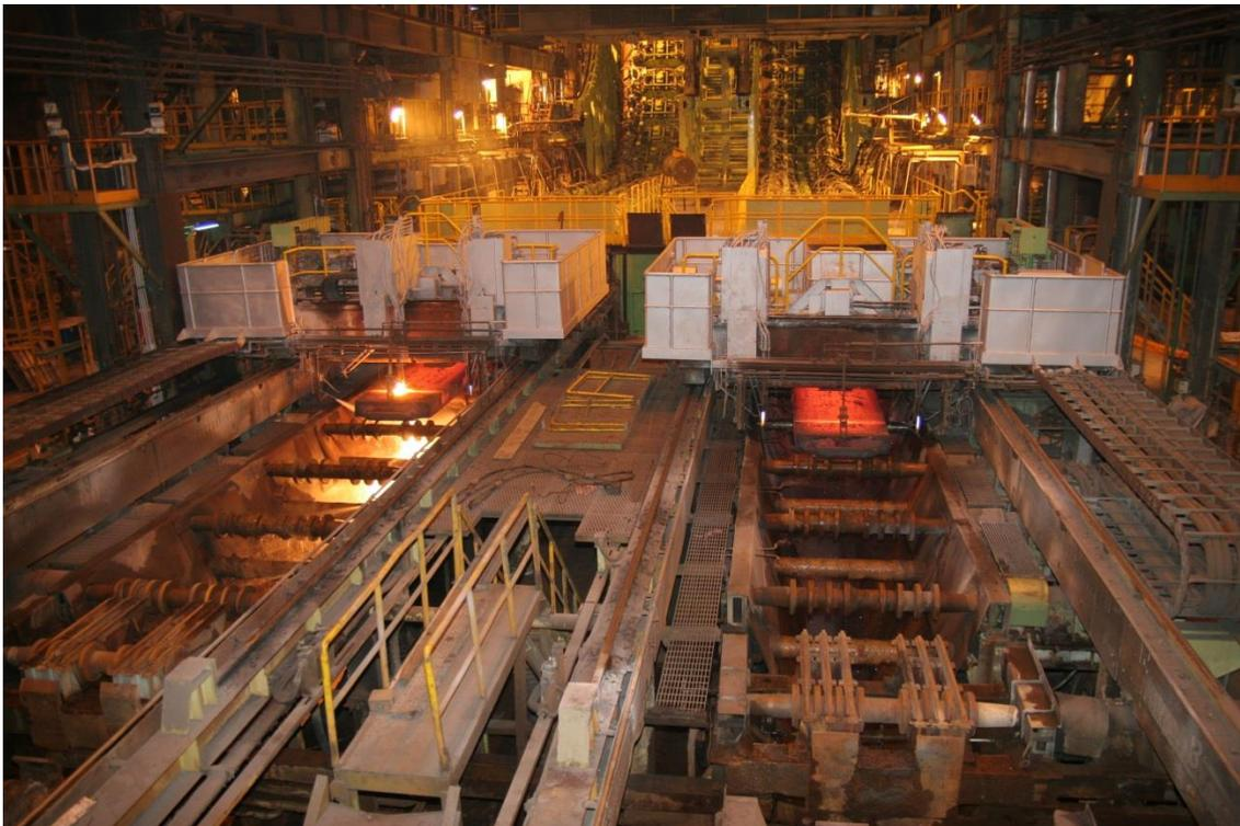
Brammenstranggießanlage im Werk Kaohsiung des taiwanesischen Stahlherstellers China Steel Corporation (CSC). Primetals Technologies wird die Gießmaschine S6 an diesem Standort modernisieren.
