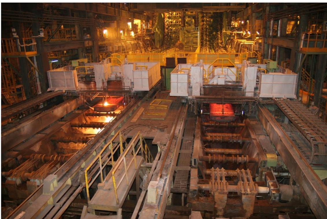
Máquina de lingotamento contínuo na usina de Kaohsiung da siderúrgica taiwanesa China Steel Corporation (CSC). A Primetals Technologies modernizará a máquina de lingotamento contínuo S6 nesta usina.
