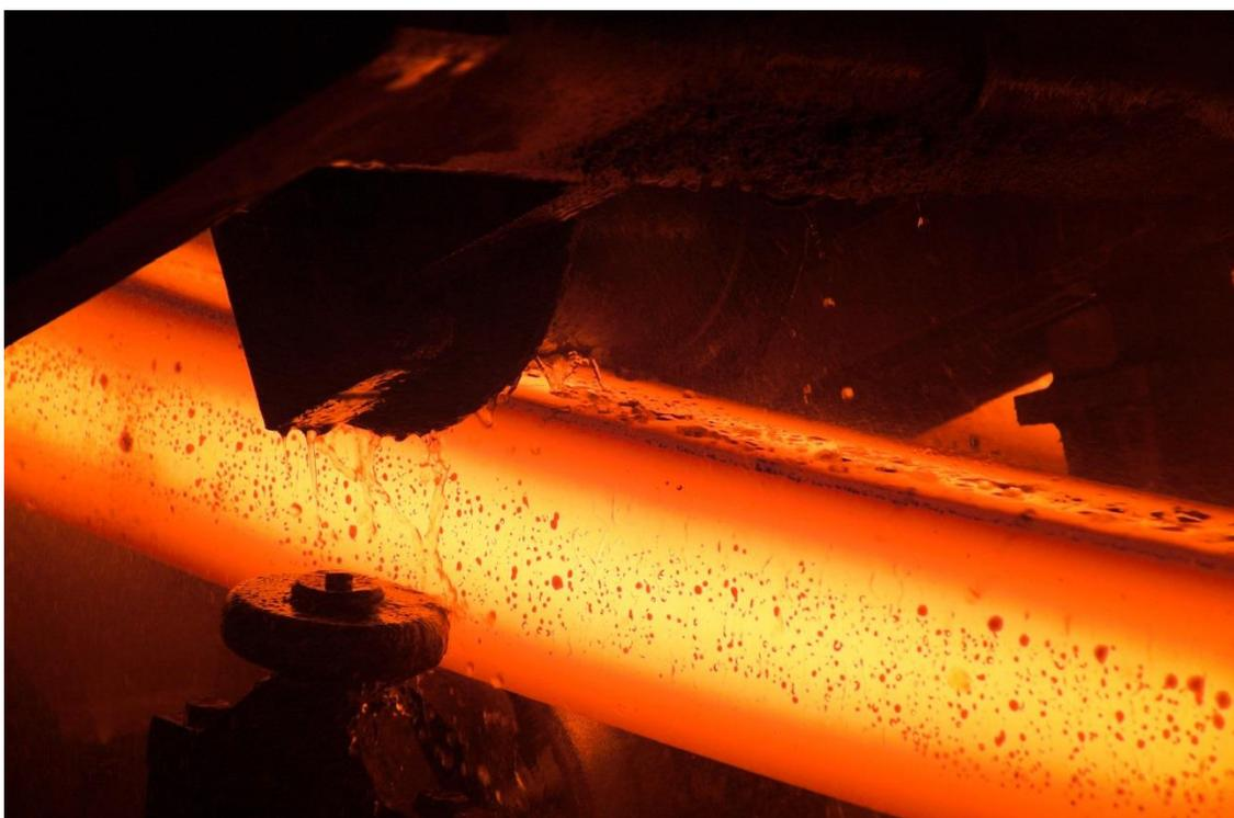
一台普锐特冶金技术小方坯连铸机的铸流导向段
