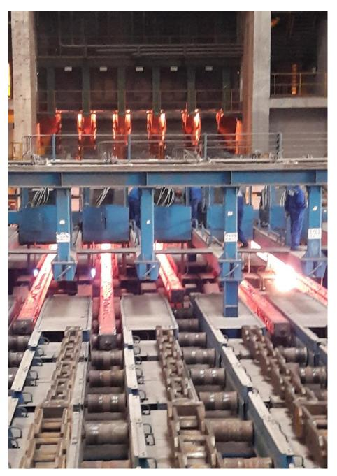
Fünfsträngige Vorblock-Stranggießanlage von Primetals Technologies bei Changzhou Zhongtian Iron & Steel (Zenith Steel), in Changzhou, China. Die Anlage ist seit März in Betrieb.
