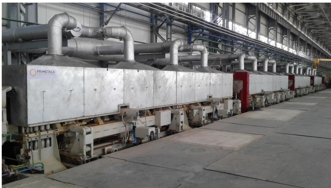
ARBZ 轧机(哈萨克斯坦 Aktobe)配备的普锐特冶金技术 idRHa+在线轨头淬火系统。
