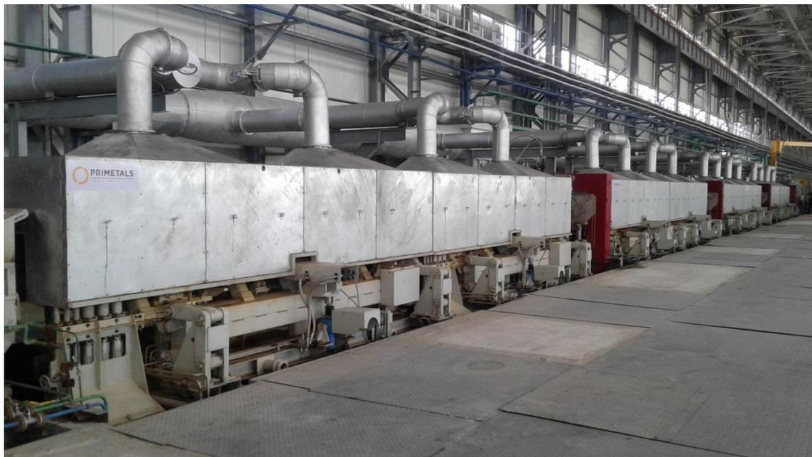
Sistema idRHa in-line de têmpera de trilho da Primetals Technologies na laminação da ARBZ em Aktobe, Cazaquistão.
