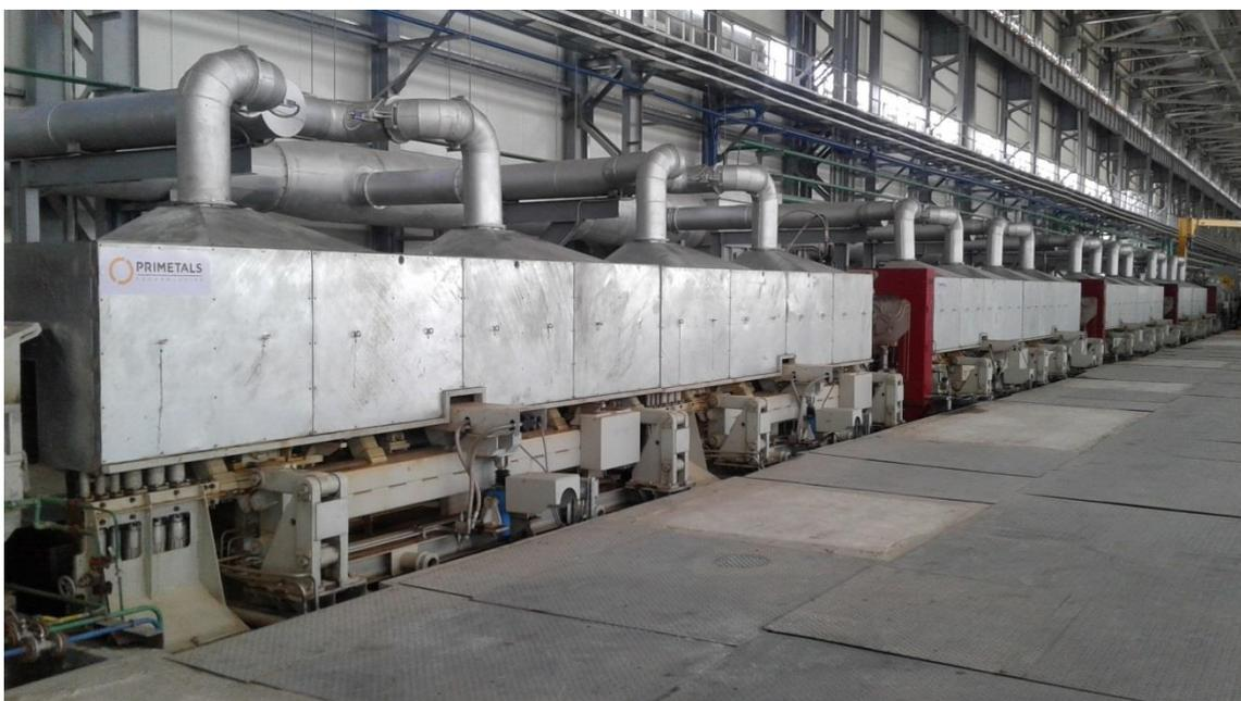
Поточная система закалки головки рельса idRna+ компании Primetals Technologies на прокатном стане АРБЗ в г. Актобе, Казахстан.
