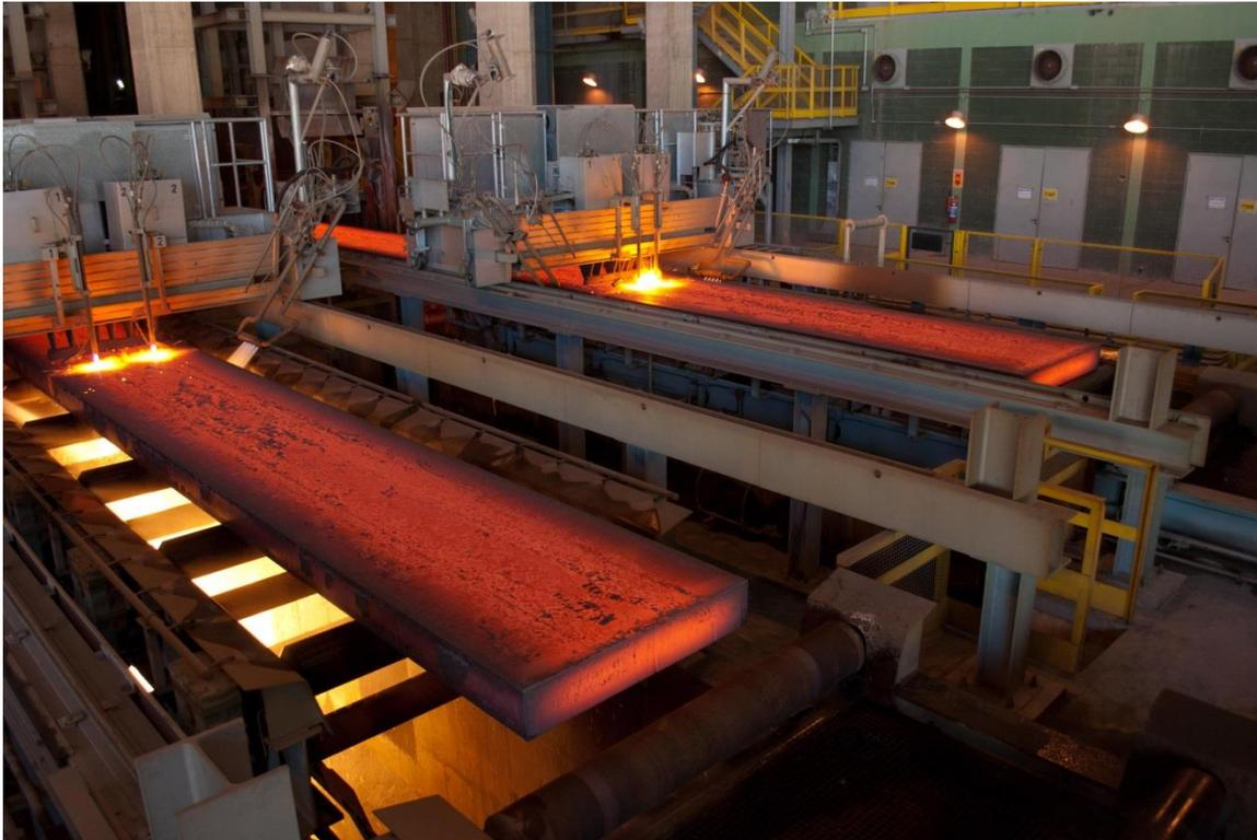
Beispiel einer Brammenstranggießanlage von Primetals Technologies. Eine ähnliche Stranggießanlage wird im Werk von JSW Steel im indischen Dolvi errichtet.
