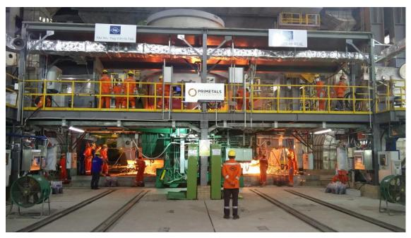
Máquina de lingotamento contínuo de placas fornecida pela Primetals Technologies, instalada na nova usina de Ha Tinh operada pela vietnamita Formosa Ha Tinh Steel Corporation. As primeiras placas foram produzidas no início de junho.
