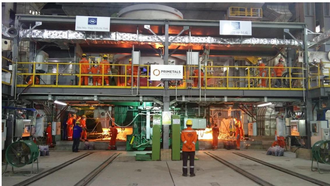
Слябовая МНЛЗ, поставленная Primetals Technologies, и установленная на новом комбинате Ha Tinh Steelworks, принадлежащем вьетнамской компании Ha Tinh Steel Corporation. Первые слябы, разлитые на установке в начале июня.
