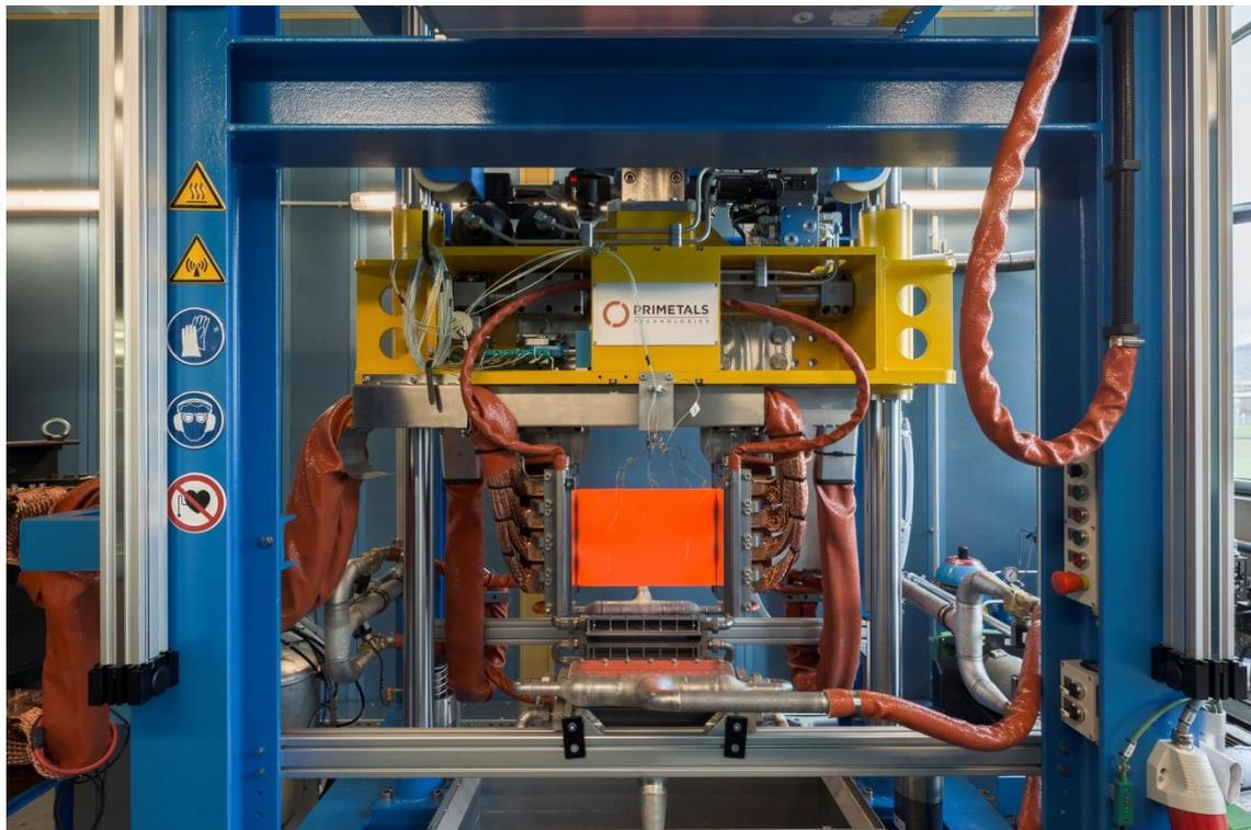
普锐特冶金技术 Multipas(多用途退火模拟器)。位于中国日照附近的山东钢铁集团日照有限公司新建钢铁厂的研究中心将安装一套这种模拟器。
