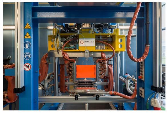
Multipas (многофункциональный симулятор отжига) от Primetals Technologies. Симулятор такого типа будет установлен в исследовательской лаборатории нового металлургического комбината Shandong Iron and Steel Group Rizhao Co., Ltd. к югу от Жичжао, Китай.
