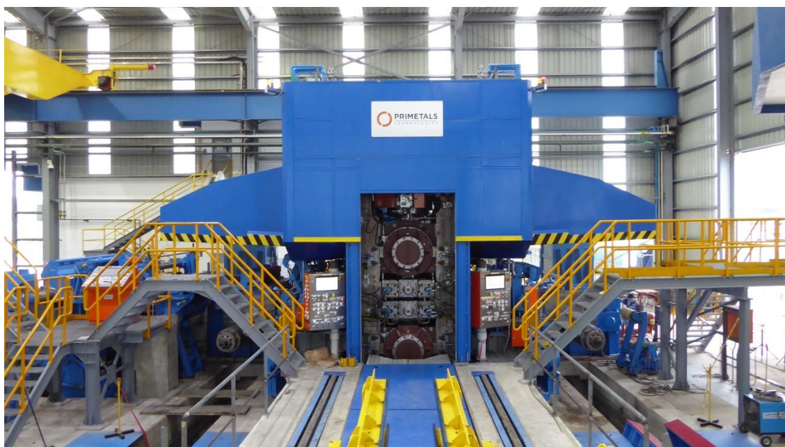
Laminador quádruo a frio reversível na TA 2000, S.A. de C.V. (Tyasa), México
