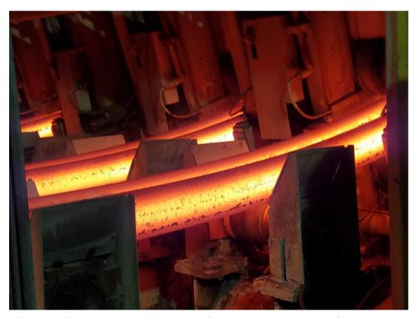
A Primetals Technologies modificou uma máquina de lingotamento contínuo na usina da Gerdau em Cartersville, Geórgia, Estados Unidos. O projeto possibilita a produção de um novo formato de blank para vigas.
