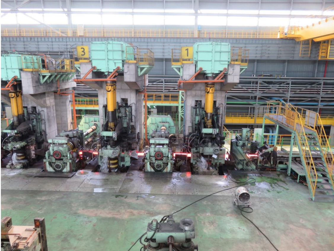
普锐特冶金技术为韩国现代钢铁公司唐津厂提供的小规格棒线材轧机
