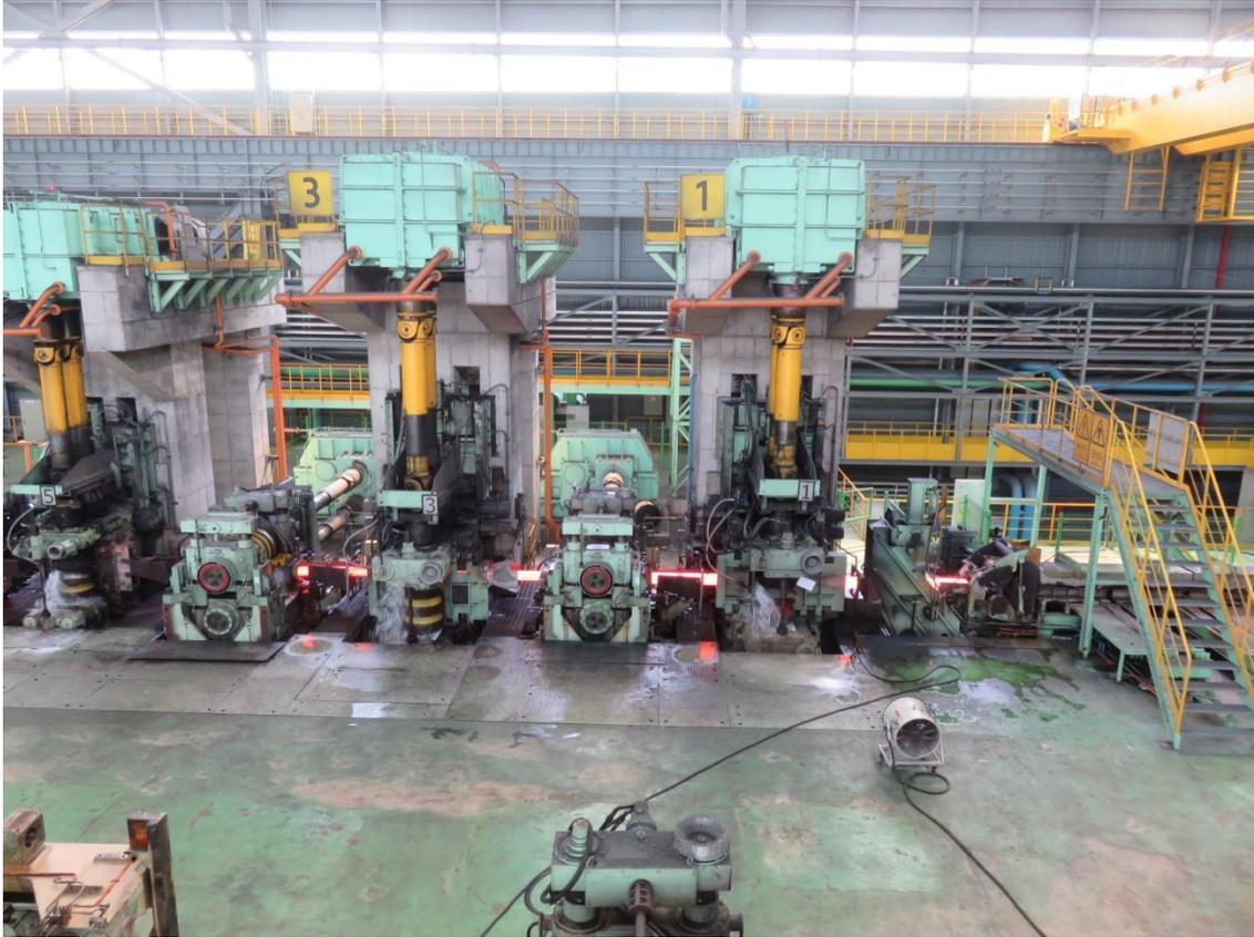
韓国の現代製鉄唐津工場にプライメタルズテクノロジーズが納入した小型棒鋼・線材圧延機
