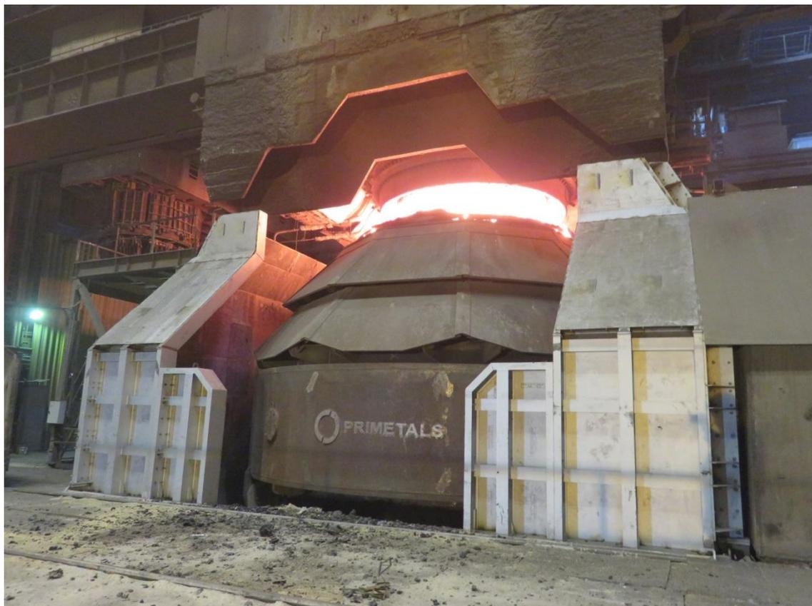
LD-(BOF-)Konverter, von Primetals Technologies im Stahlwerk Dąbrowa Górnicza für ArcelorMittal Poland S.A. errichtet
