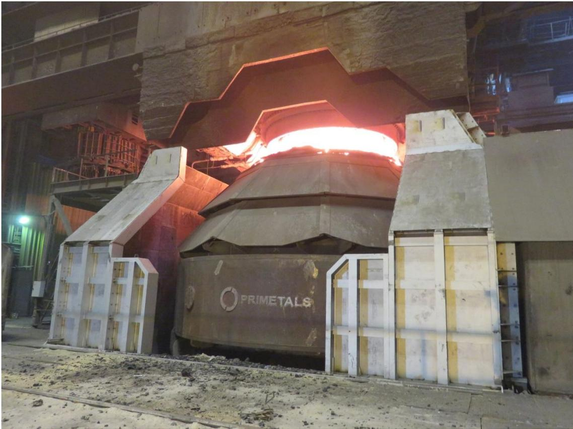
プライメタルズテクノロジーズがアルセロールミッタルポーランドのドンブロヴァ・グルニチャ製鉄所に納入したLD（BOF）転炉
