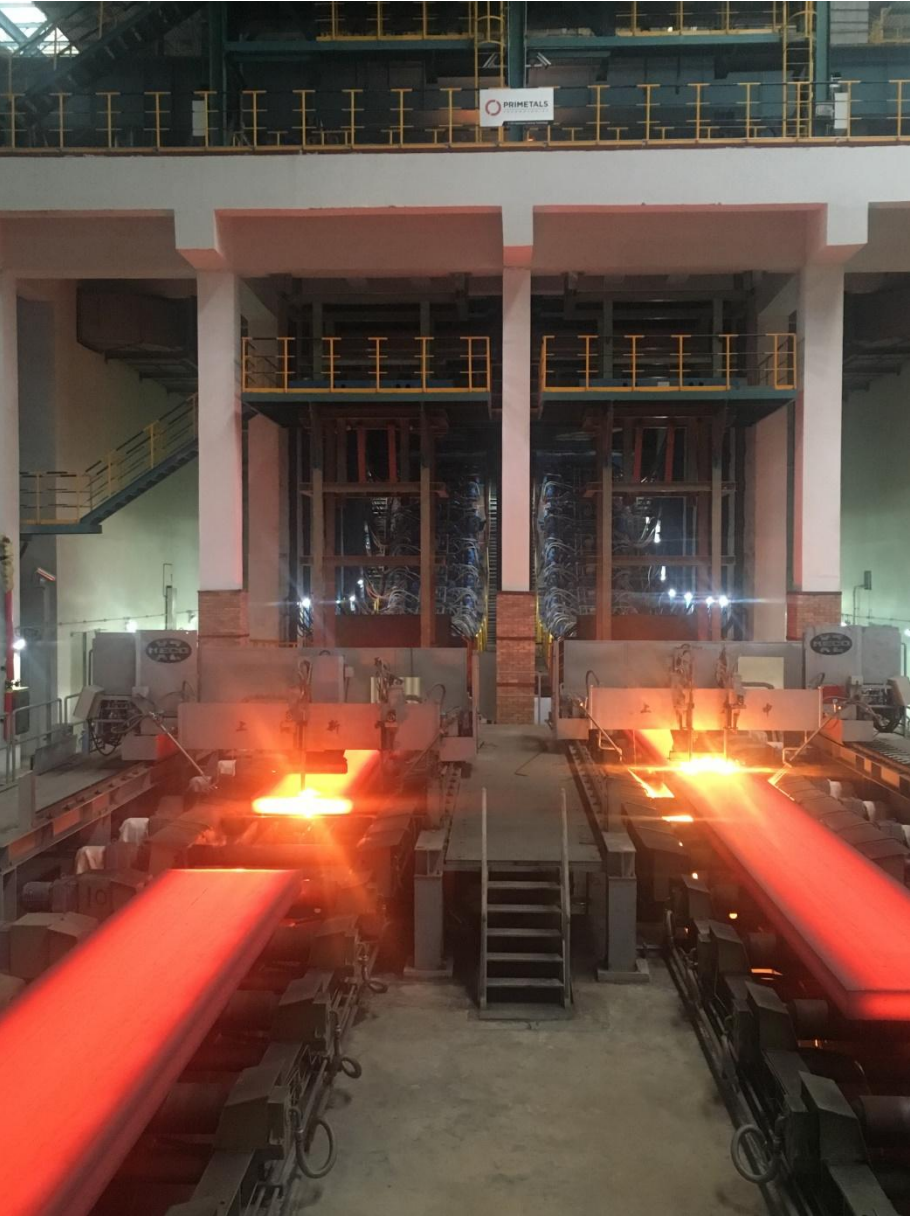
中国钢铁企业山东钢铁集团日照有限公司安装的普锐特冶金技术 双流板坯连铸机
