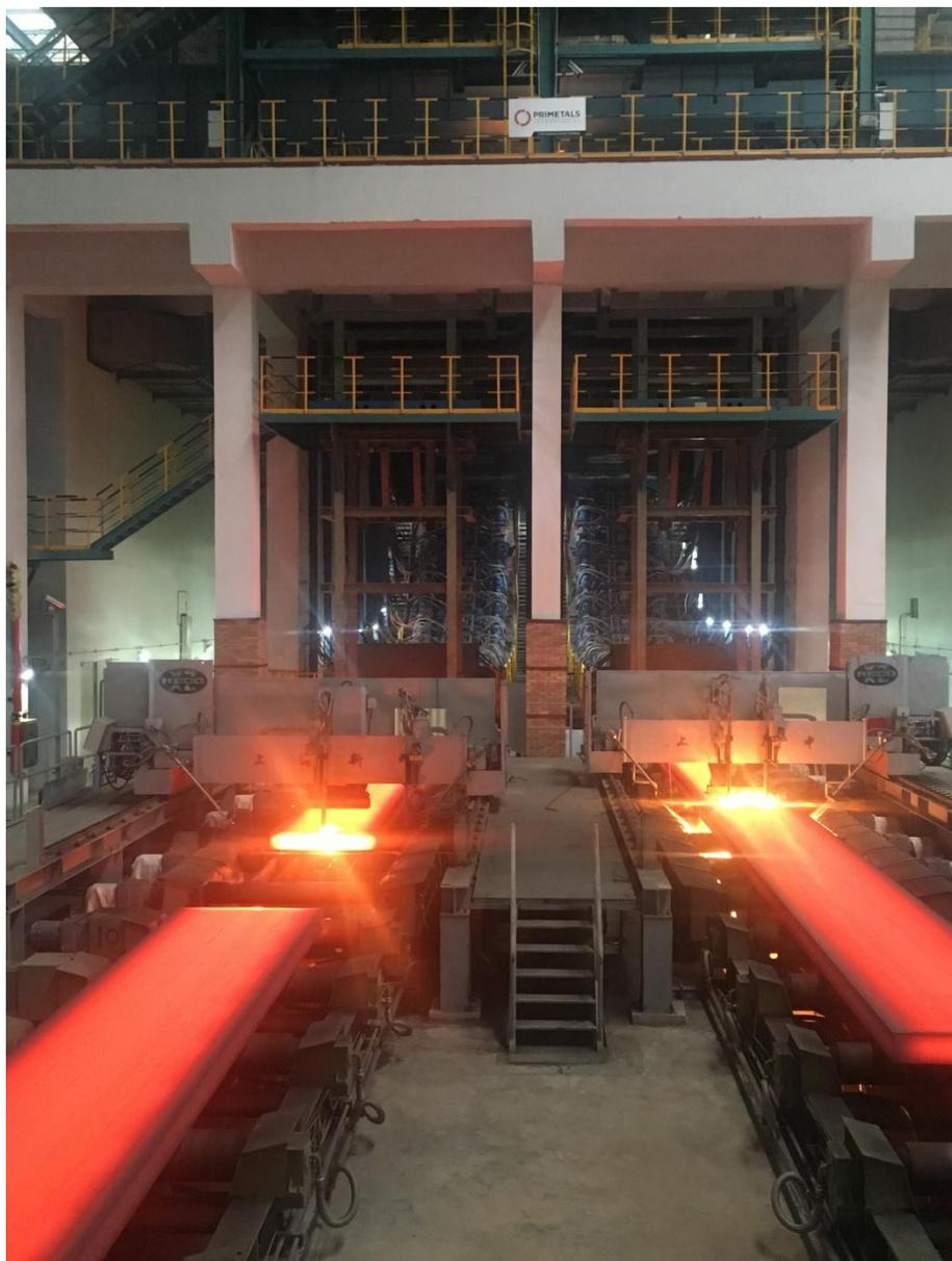
プライメタルズテクノロジーが中国の山東鋼鉄に2ストランド（条）式スラブ連続鑄造機2基を引渡し
