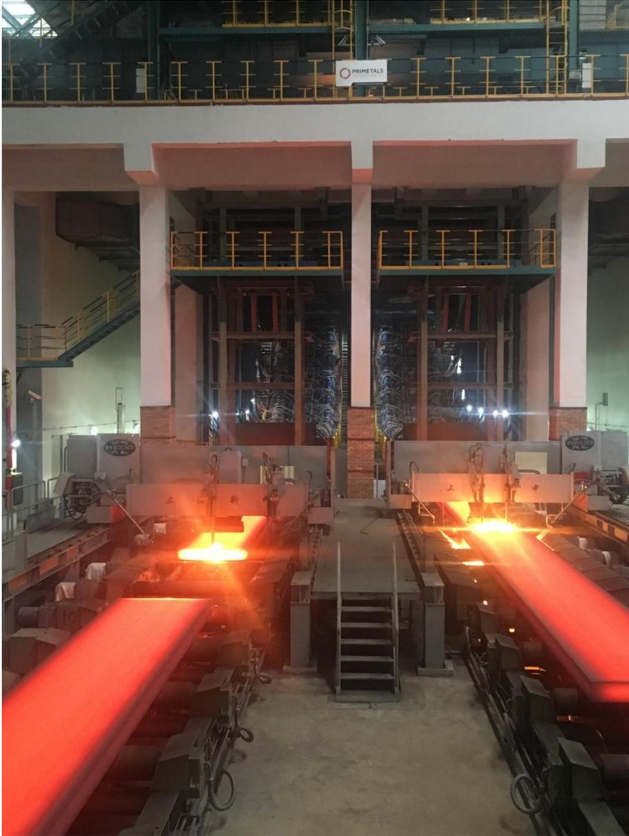
Máquina de lingotamento contínuo de placa de dois veios da Primetals Technologies na siderúrgica chinesa Shandong Iron & Steel Group Rizhao Co. Ltd.
