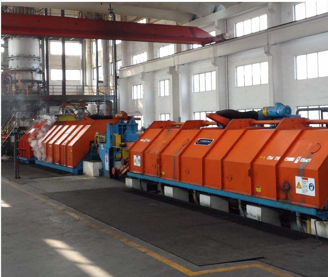
Стан прокатки медной катанки SCR-7000, поставленный Primetals Technologies
