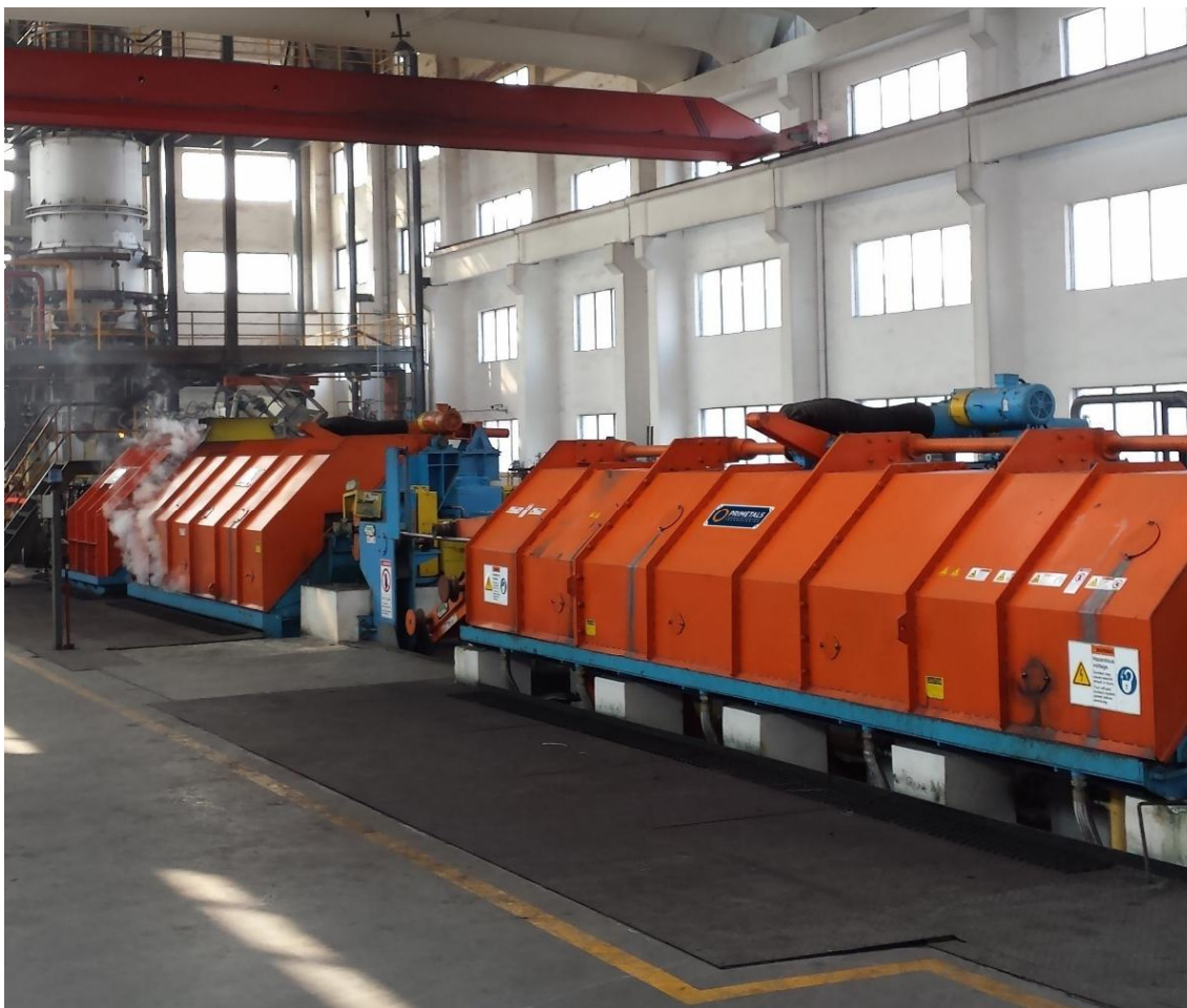
Laminador SCR-7000 de barras de cobre fornecido pela Primetals Technologies para a Southwire Company, LLC.
