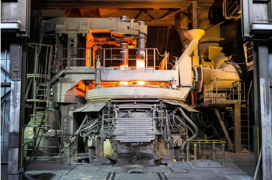
Von Primetals Technologies modernisierter Elektrolichtbogenofen bei der BGH
