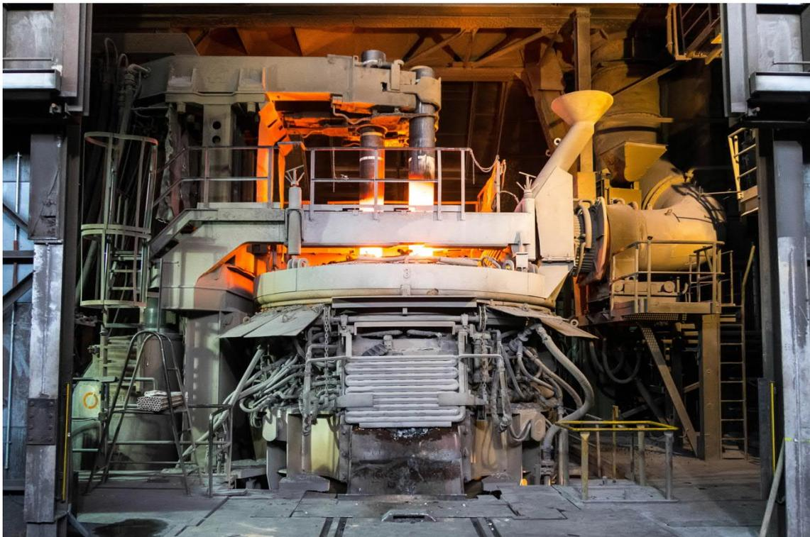
Модернизированная Primetals Technologies ДСП на площадке BGH Edelstahlwerke GmbH в г. Фрайталь, Германия
