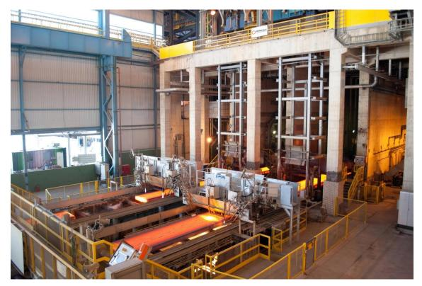
O segmento SRD (Single-Roll DynaGap) recentemente desenvolvido pela Primetals Technologies proporciona uma melhor qualidade interna da placa em máquinas de lingotamento contínuo. A primeira aplicação na usina integrada da Ternium em Santa Cruz, Brasil, resultou em significativa melhoria da qualidade interna das placas.
