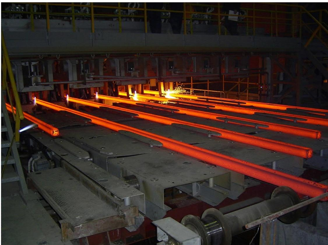
Diese sechssträngige Knüppelstranggießanlage von Feralpi Siderurgica im Werk Lonato del Garda, Italien, soll von Primetals Technologies modernisiert werden.
