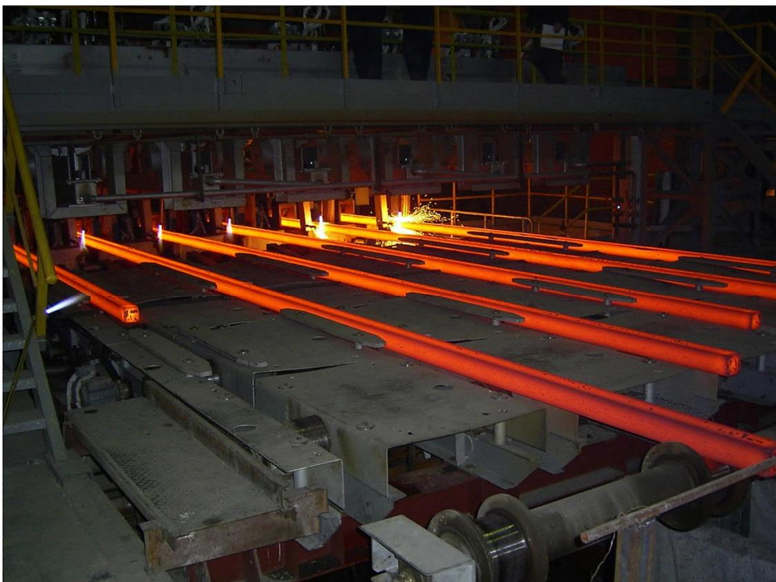
Máquina de lingotamento contínuo de tarugos de seis veios que será modernizado pela Primetals Technologies, na usina da Feralpi Siderurgica em Lonato del Garda, Itália.
