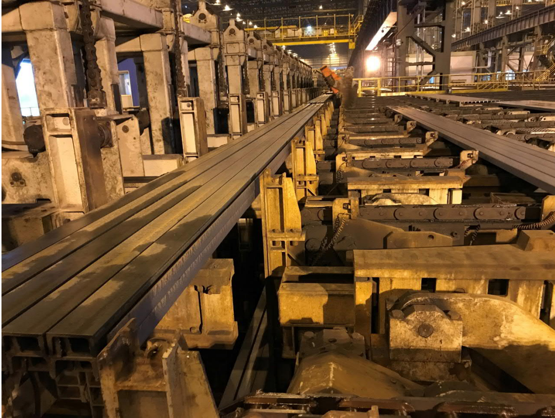
Estação de empilhamento de perfis da Primetals Technologies
