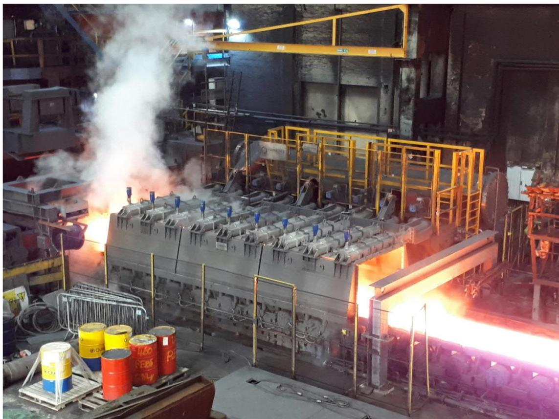
Vorbandkühlanlage von Primetals Technologies in der Warmwalzstraße des integrierten Stahlwerks Port Talbot von Tata Steel in Südwales, Großbritannien.
