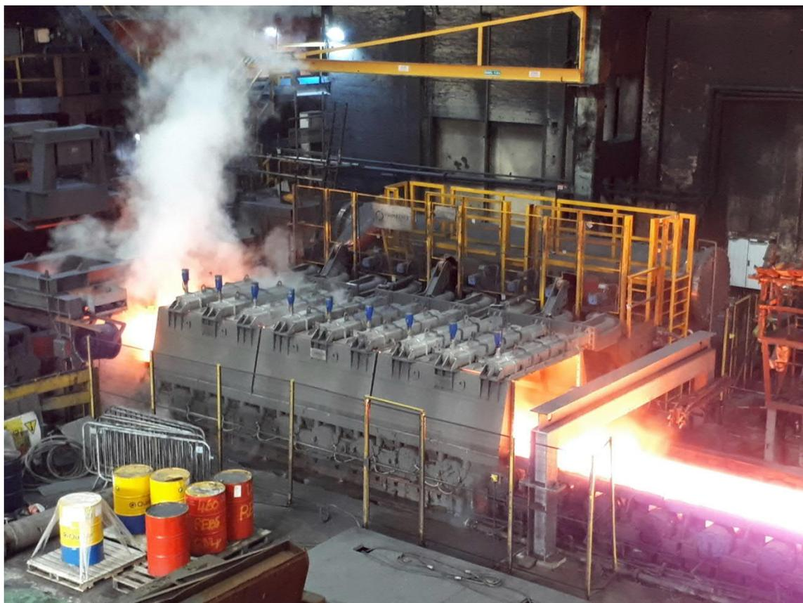
プライメタルズテクノロジーズのシートバー冷却システムを英国・南ウェールズにあるタタ・スチールのポート・タルボット製鉄所向けに熱間圧延機用として納入。
