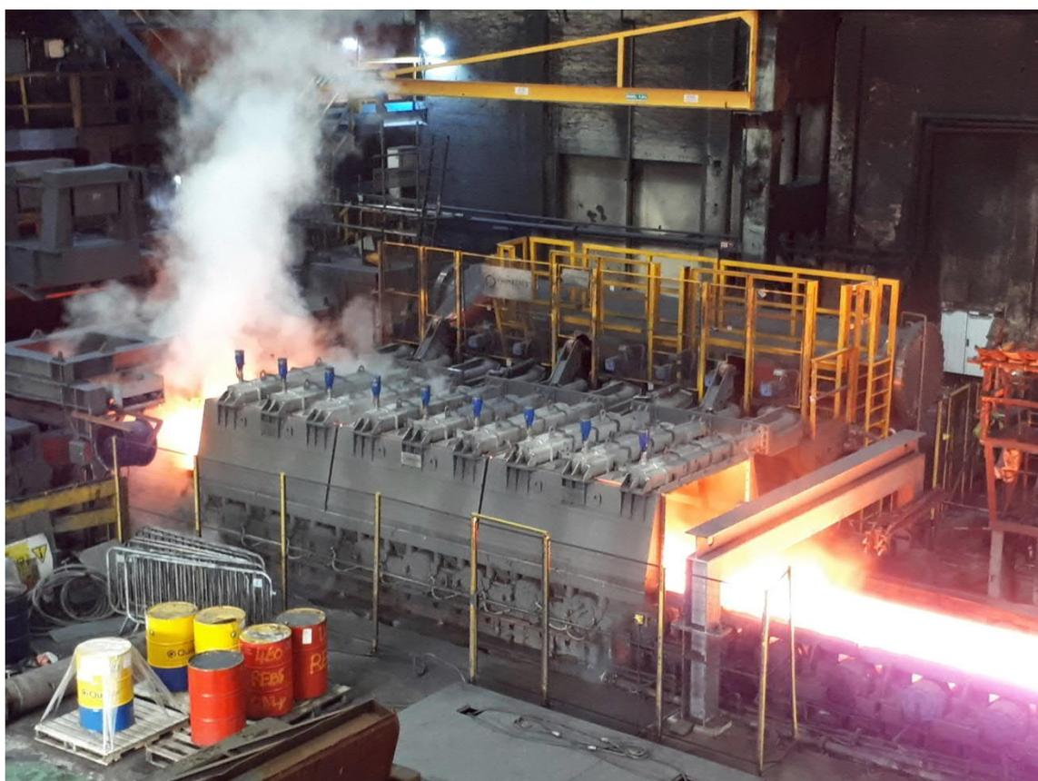
Sistema de resfriamento da barra de transferência da Primetals Technologies instalado no laminador de tiras a quente da usina integrada de Port Talbot da Tata Steel, localizada em South Wales, Reino Unido.
