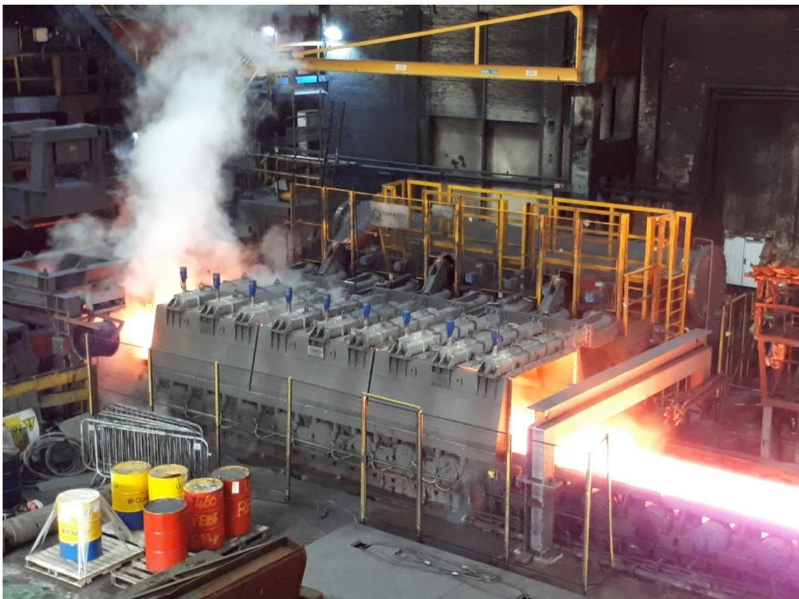
Система охлаждения раската, поставленная Primetals Technologies, установленная на стане горячей прокатки на заводе Tata Steel в г. Порт-Толбот, Южный Уэльс (Великобритания).
