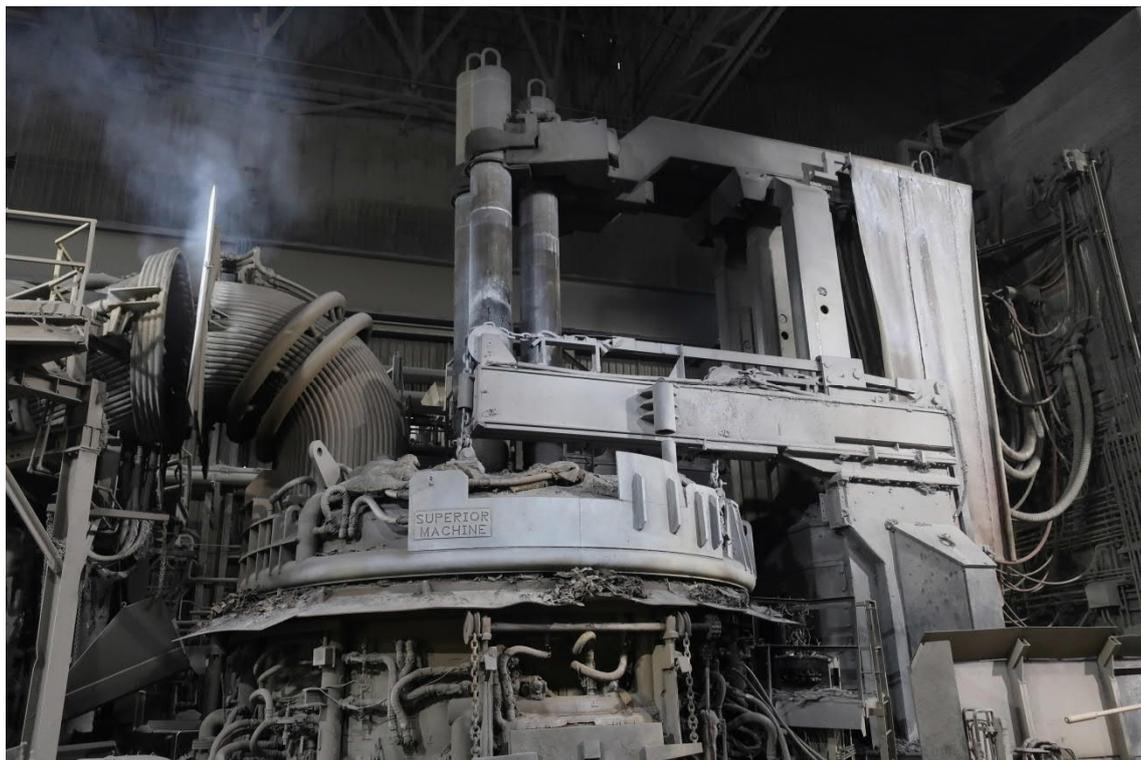
Elektrolichtbogenofen von Gerdau Special Steel North America im Elektrostahlwerk des Unternehmens in Monroe, Michigan, USA. Primetals Technologies modernisiert den Elektrolichtbogenofen und liefert einen neuen Doppelpfannenofen und eine neue Materialhandhabung (Foto: Gerdau Special Steel North America).
