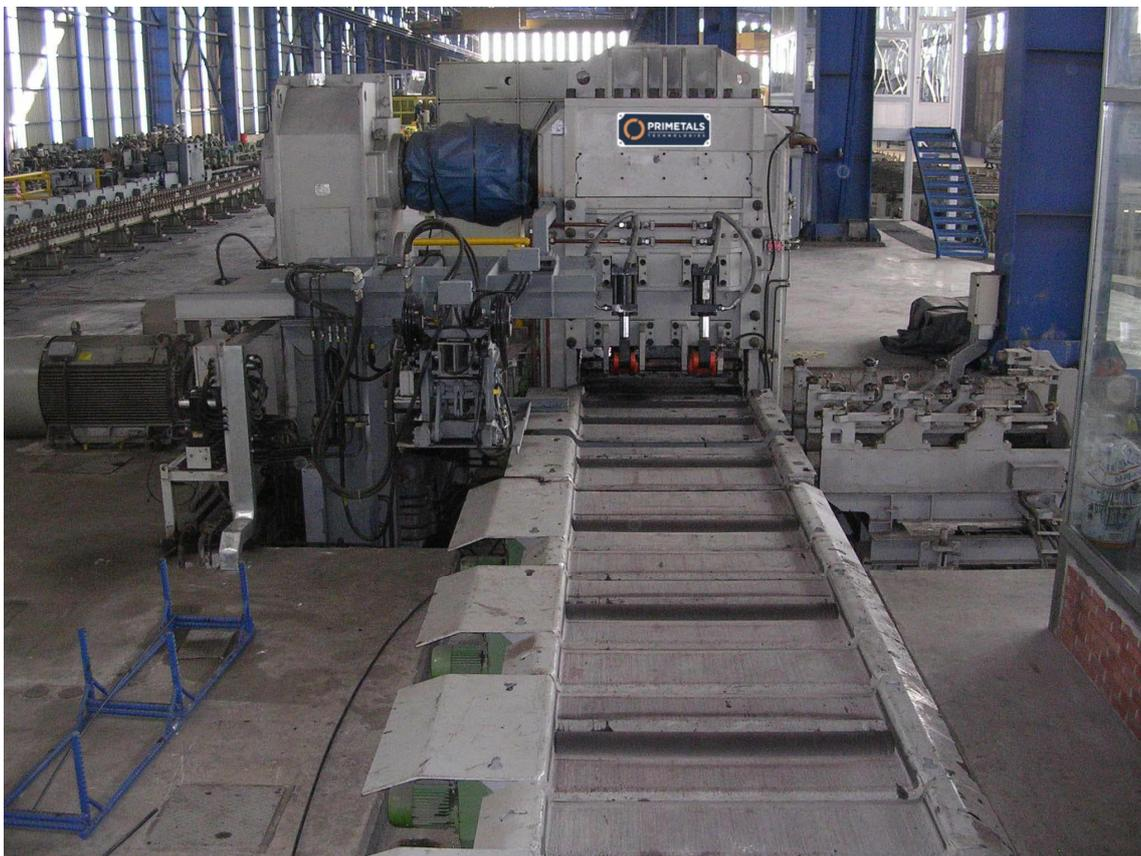
Cesoia statica per taglio a freddo in un laminatorio per barre di Primetals Technologies.
