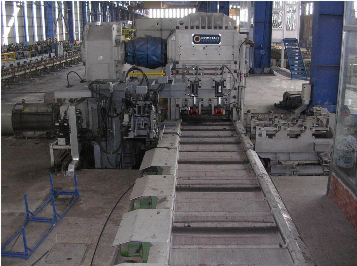
Tesoura a frio e mesa de saída de laminador de barras de Primetals Technologies
