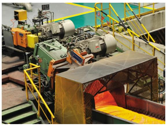
Eine Morgan Treibrolle des Typs "Intelligent Pinch Roll" und ein Morgan Hochgeschwindigkeits-Windungsleger von Primetals Technologies
