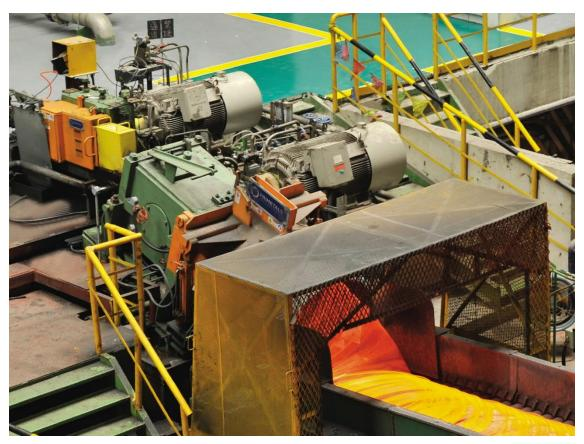
Trascinatore "intelligente" e testa forma-spire ad alta velocità con tecnologia Morgan di Primetals Technologies
