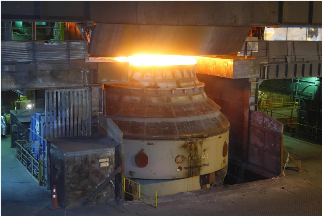
プライメタルズテクノロジーズがチリ・タルカワノの CAP Acero 社（Compania Siderurgica Huachipato S.A.）製鉄所に設置した BOF 転炉 2 号基の最初の溶解処理。
