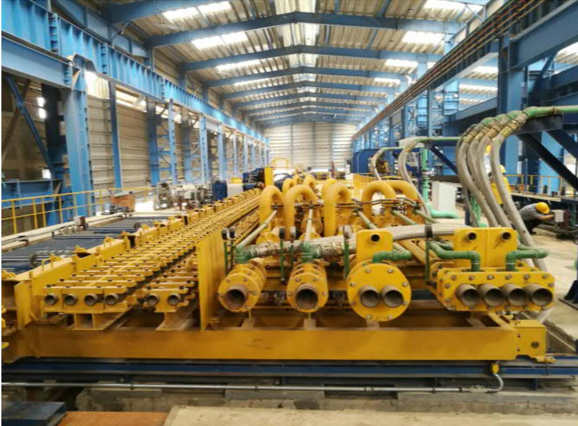
普锐特冶金技术在线 PQS 淬火系统使产品表面产生回火马氏体，芯部则是铁素体-珠光体组织。普锐特冶金技术为巴基斯坦 Naveena 钢铁公司短流程钢厂项目提供的小方坯连铸机和螺纹钢轧机的供货范围中就包括了 PQS 系统。
