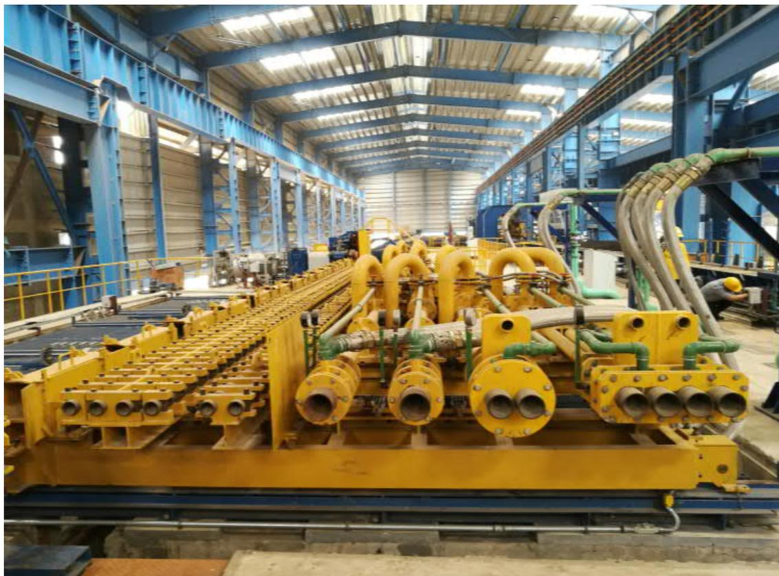
Die PQS-Inline-Vergütungsline von Primetals Technologies verleiht Stäben eine gehärtete martensitische Außenschicht und einen ferritisch-perlitischen Kern. PQS ist Bestandteil einer von Primetals Technologies gelieferten Knüppelstranggießanlage und eines Bewehrungsstahlwalzwerks für das geplante Miniwalzwerk von Naveena Steel in Pakistan.
