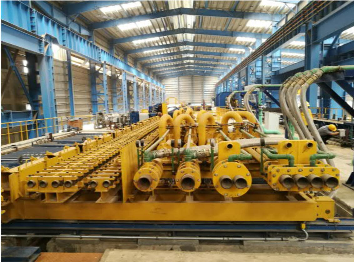
Il sistema di tempra in linea PQS conferisce alle barre una struttura esterna in martensite temprata e un nucleo in ferrite-perlite. Il PQS fa parte della fornitura di Primetals Technologies di una colata continua per billette e di un laminatoio per barre per armature, per il progetto minimill di Naveena Steel in Pakistan.
