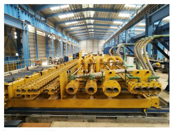
O sistema de têmpera PQS in-line da Primetals Technologies proporciona aos vergalhões uma superfície martensítica revenida e um núcleo ferrítico-perlítico. O PQS faz parte do fornecimento pela Primetals Technologies de uma máquina de lingotamento contínuo de tarugos e um laminador de vergalhões para o projeto de mini-mill da Naveena Steel, Paquistão.
