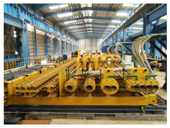
Система закалки PQS от Primetals Technologies позволяет получать арматуру с закаленной мартенситной поверхностью и феррито-перлитной внутренней частью. В объем поставки для нового мини-завода Naveena Steel в Пакистане, куда Primetals Technologies поставит сортовую МНЛЗ и сортопрокатный стан, также вошла система закалки PQS.
