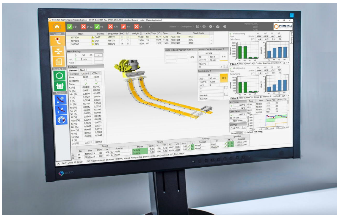
Sistema de otimização de processo: vista geral da máquina de lingotamento contínuo
