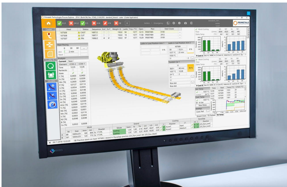
Система оптимизации технологического процесса: общий экран МНЛЗ
