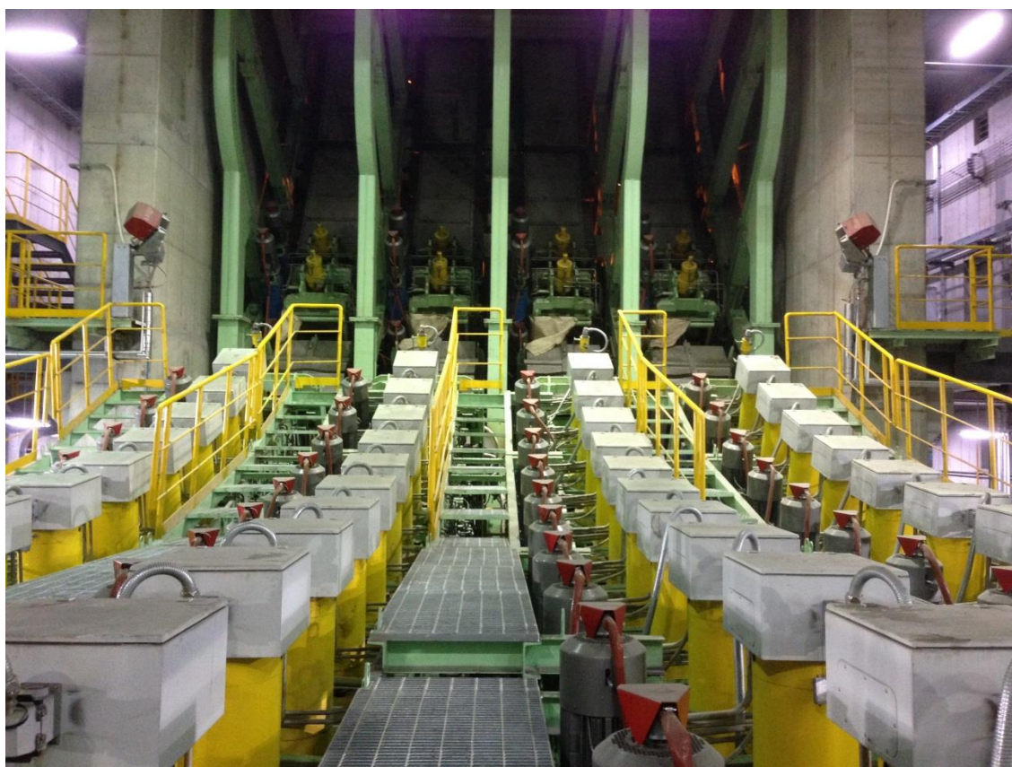
Seção curva de uma máquina de lingotamento contínuo de blocos da Primetals Technologies.
