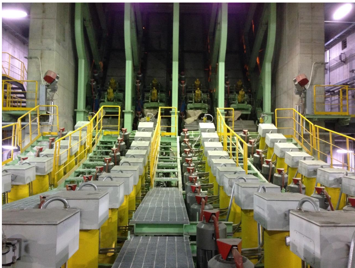
Разливочная дуга блюмовой МНЛЗ от Primetals Technologies
