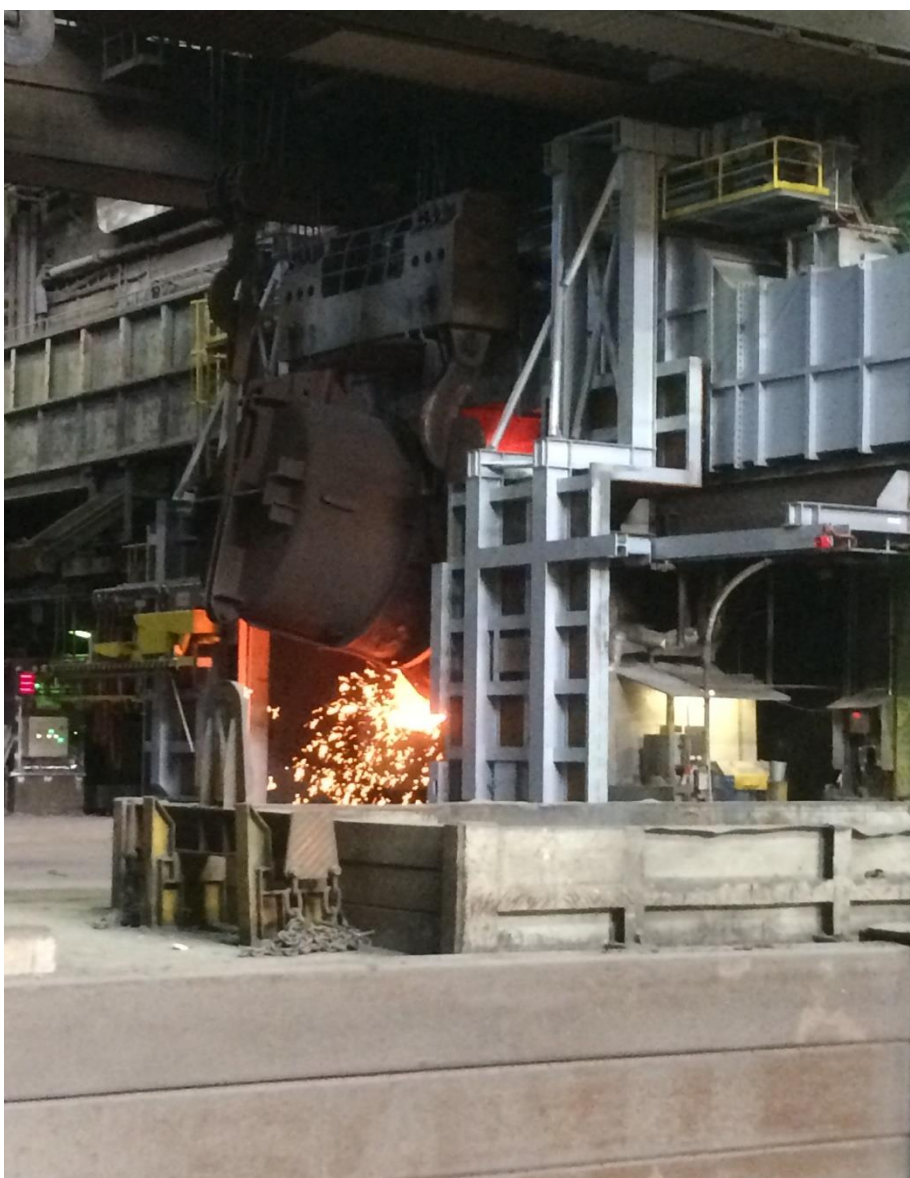
LD(BOF)-Konverter von Primetals Technologies bei ArcelorMittal
